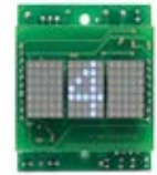
■ 20 mm 2 dígitos alfa numérico ■ 70 mm 2 dígitos alfa numérico ■ 40 mm 2 dígitos matriz de punto ■ 18 mm 3 dígitos matriz de punto
