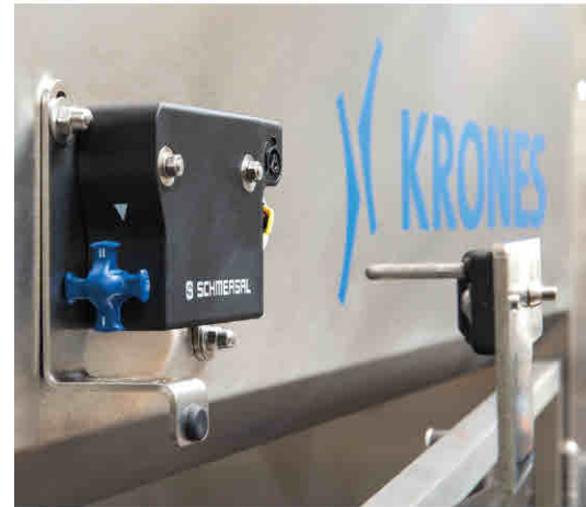
Die energieeffiziente AZM300 ist vielseitig einsetzbar aufgrund eines neuartigen Zuhaltesystems
