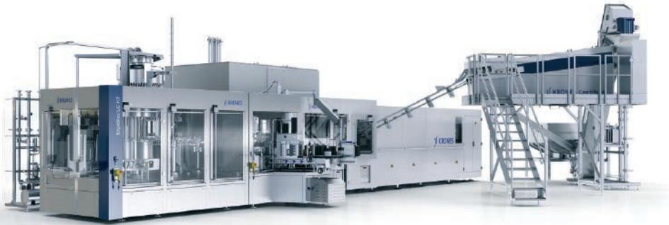
**In den Abfüllanlagen von Krones wurden der Sicherheitssensor RSS36 und die Sicherheitszuhaltung AZM300 integriert. Beide Komponenten erreichen aufgrund der integrierten RFID-Technologie die Codierstufe „hoch“ gemäß EN ISO 14119.**
