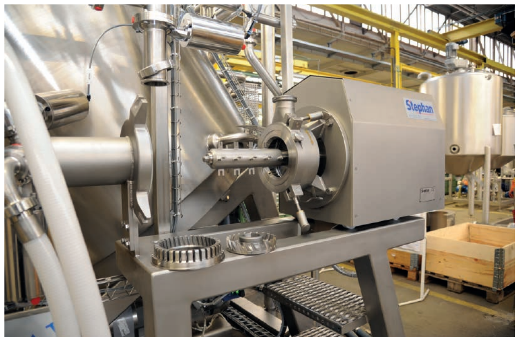
■ Abb. 3: Der Microcut, der sich in einem robusten Edelstahlgehäuse befindet, verfügt über verschiedene Schneidwerkzeuge.
