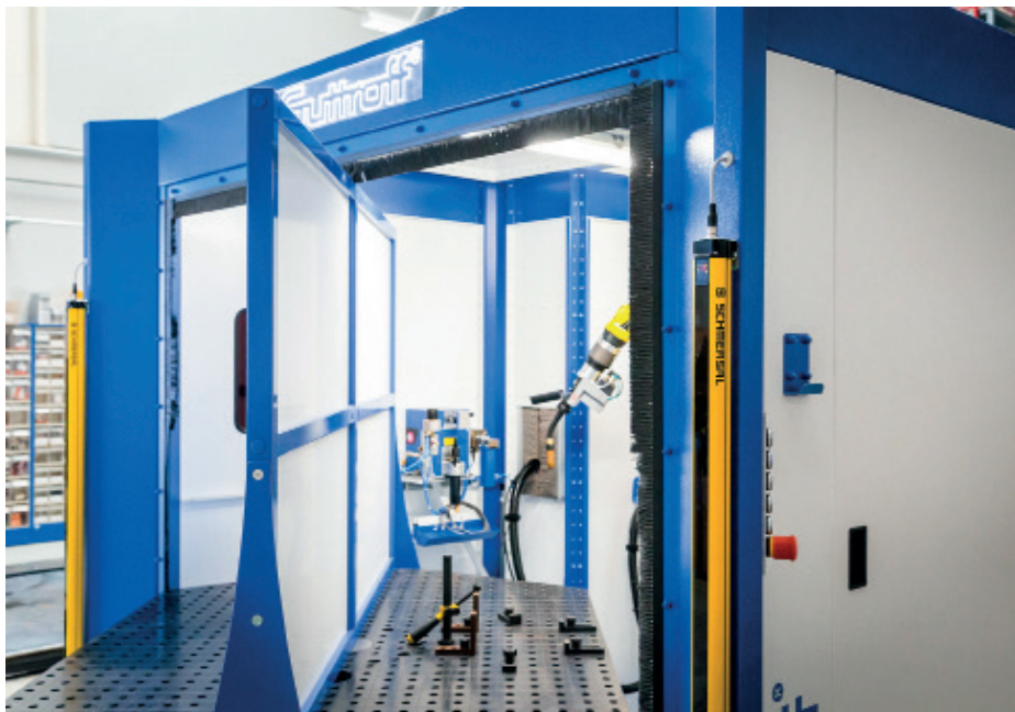
02 Der Bereich um den Wendetisch ist mit einem Sicherheitslichtvorhang des Typs SLC420 von Schmersal abgesichert
