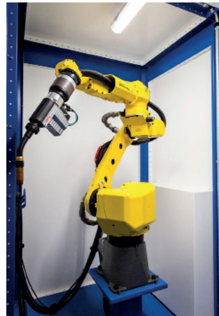
03 Die Zelle umhast einen Schweißroboter des Typs Fanuc Arc Mate 100 IC
