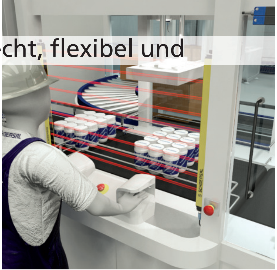
Sicherheitssysteme gewährleisten zuverlässig eine hohe Anlagenverfügbarkeit – dazu zählen auch optoelektronische Sicherheitslösungen wie etwa Lichtgitter. Bild: Schmersal
