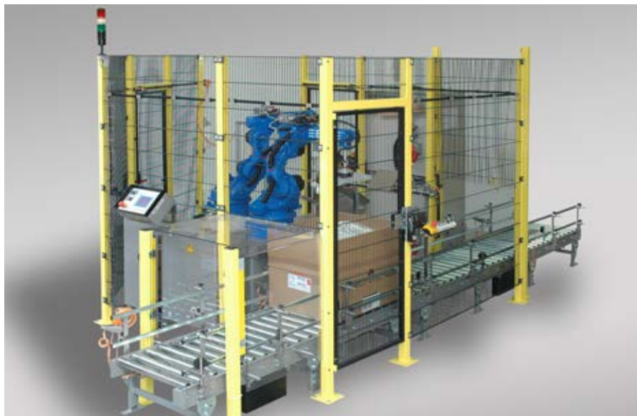
Instalaciones en las que trabajan robots son muy habituales en la producción y el embalaje. Su zona de trabajo tiene que estar separada de la del operador – generalmente a través de un resguardo de protección. (Imagen: ETT Verpackungstechnik)
