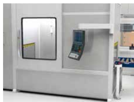
01 En grandes máquinas-herramienta los resguardos de protección y los pernos de cierre con frecuencia son accionados de forma eléctrica
