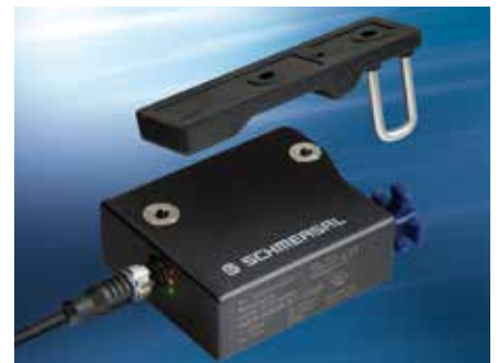
03 Los sensores integrados para la monitorización de la posición del perno de cierre en el actuador están basados, como en el AZM 300 que se muestra, en tecnología RFID. El estado de salida del perno de cierre es supervisado por solenoides.
