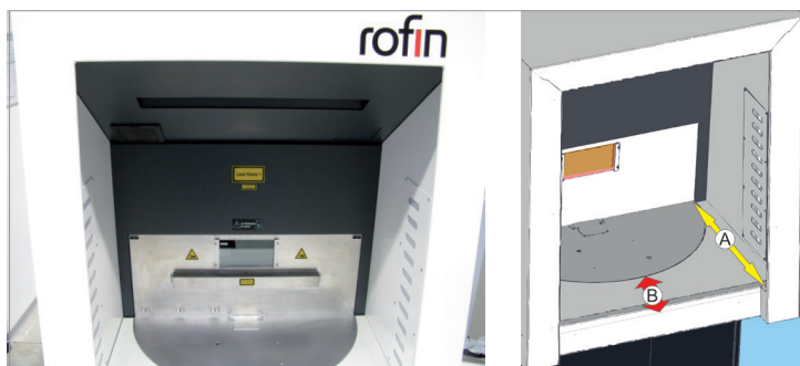
In seguito all'intervento di riprogettazione, i progettisti di Rofin hanno eseguito una rilevazione delle aree di pericolo e delle distanze dai punti di taglio e schiacciamento.
