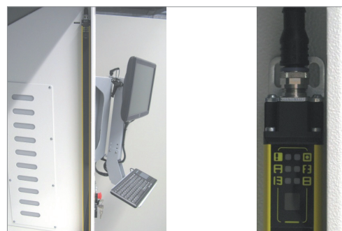
In virtù della loro compattezza, le barriere ottiche di sicurezza si integrano perfettamente nella struttura circostante.
