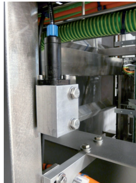
All'occorrenza, Dienst utilizza il sensore RSS 36 abbinato ad una ritenuta pneumatica.
