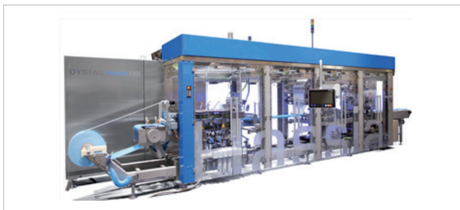
La nuova P300 di Hassia è una macchina confezionatrice per la termoformatura, il riempimento e la sigillatura con fascia di potenza medio-bassa.
