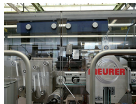
In un tipico impianto Meurer, sono installati da otto a dieci dispositivi di commutazione di sicurezza per il controllo di posizione delle porte di protezione. Qui due MZM 100 a protezione di una porta a due ante.
