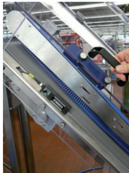
L'MZM 100 trova idonea applicazione anche nelle porte di protezione più piccole, come in questo caso lo sportello di un nastro trasportatore.
