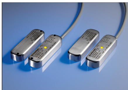
Figura 1: I sensori di sicurezza offrono proprio nella costruzione delle macchine per il settore alimentare molti vantaggi rispetto agli interruttori di sicurezza elettromeccanici. La figura mostra il sensore BNS 40S, sviluppato specificatamente per gli ambienti igienici della produzione alimentare.
